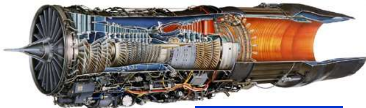
Silnik F100-PW-229 (stosowany w F-16A)
