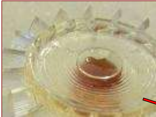
Model odlewu wirnika turbiny (μSO-1) wykonany metodą SL
